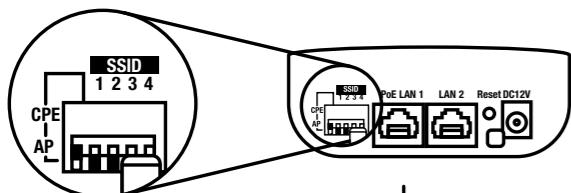
b) Stellen Sie sicher, dass die Dips 1 bis 4 gleich positioniert und an allen Bridges identisch sind.
